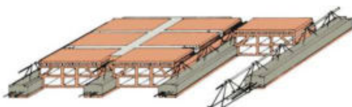
Ziegeldecke nach DIN 1045 mit Deckenziegel nach DIN 4159
